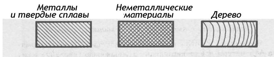
**Рис. 198.** Некоторые графические обозначения материалов
